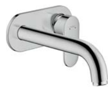
FALSÍK ALATTI EGYKAROS FALI MOSDÓCSAPTELEP - Kifolyócső hossza: 20.7 cm - A fogantyú jobb és bal oldalra is szerelhető #71576, -000 #71576, -670 Szükséges alaptest: #13622180
